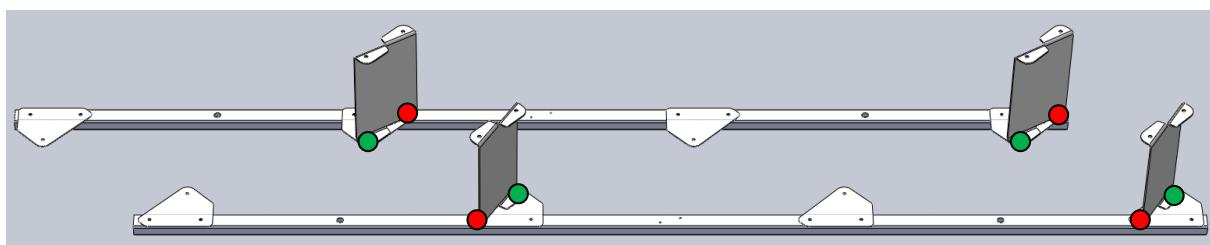
Visser les réhausseurs sur les platines en respectant l'orientation de l'âme (cf. ci-dessous) et en mettant les vis (point rouge) ou les vis+écrous (point vert).
