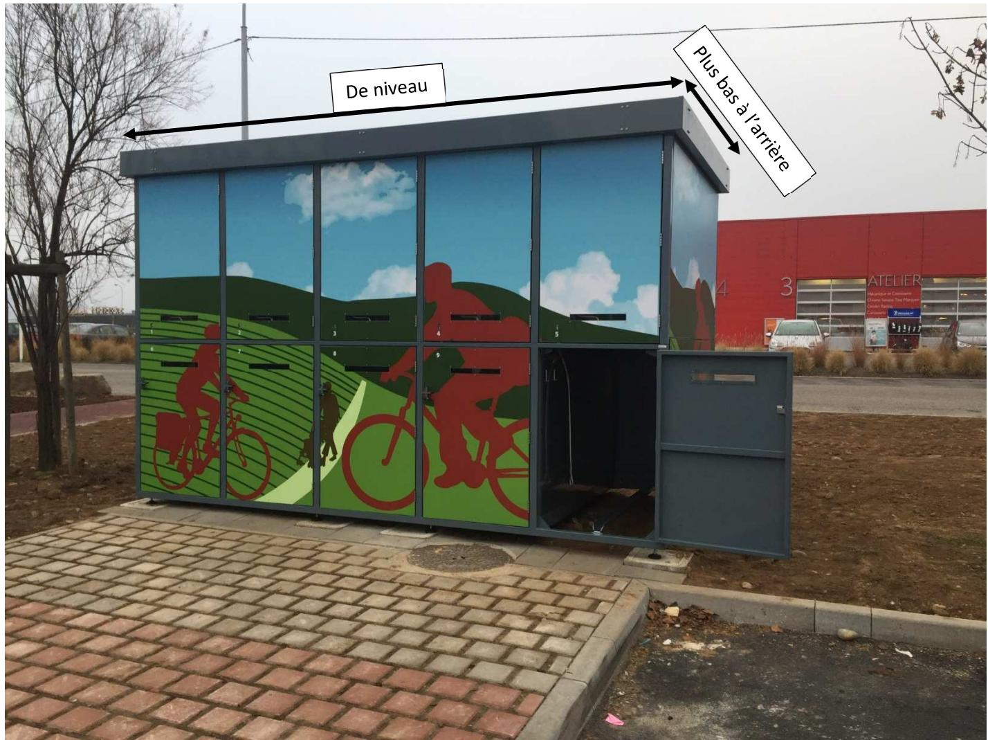
Si les niveaux ne sont pas conformes, affiner le réglage des pieds à l'aide de la clé de mécanicien et d'un cric hydraulique de manutention pour diminuer l'effort sur les pieds
